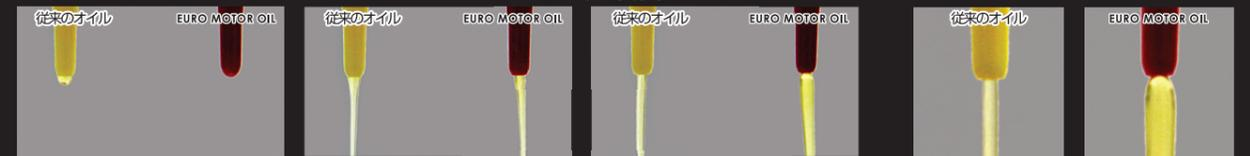
従来のオイルとは異なり、EURO MIXは密封されたところでは横に広がろうとする特性があります。縦方向の力を受けるとその力の直角方向に力が発生し横に広がろうとし、従来オイルでは細くなるのに比べ、膨らむ現象を見せます。これによりエンジンのあらゆる部分に浸透し、強力な油膜をつくることで密封効果を高めます。
