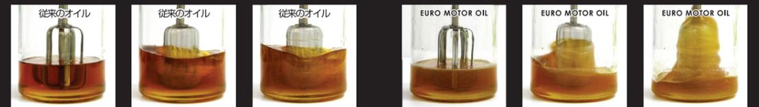
従来のオイルとは異なり、非ニュートン流体の粘弾性効果により回転している軸に絡みついて上昇します。これにより潤滑部分に常にオイルが満たされ、油膜切れを防止します。浸透した油膜は長時間保持されエンジン劣化原因のエンジン始動時の初期摩耗防止効果を発揮します。
